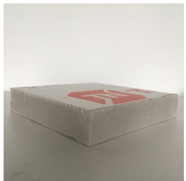
Рис. 7 Опытные образцы ТЕХНОНИКОЛЬ CARBON PROF после испытаний
