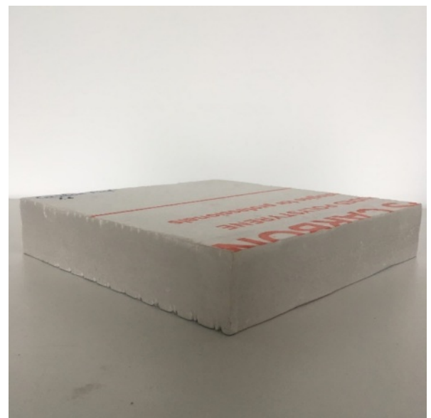
Рис. 6 Опытные образцы ТЕХНОНИКОЛЬ CARBON PROF после испытаний
