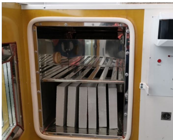
Рис. 2 Образцы в климатической камере в процессе испытаний
